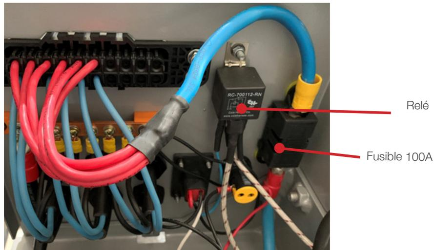
Ubicado dentro del relé, y desenganche los cables interconectados. A continuación, desenrosque y reemplace.
