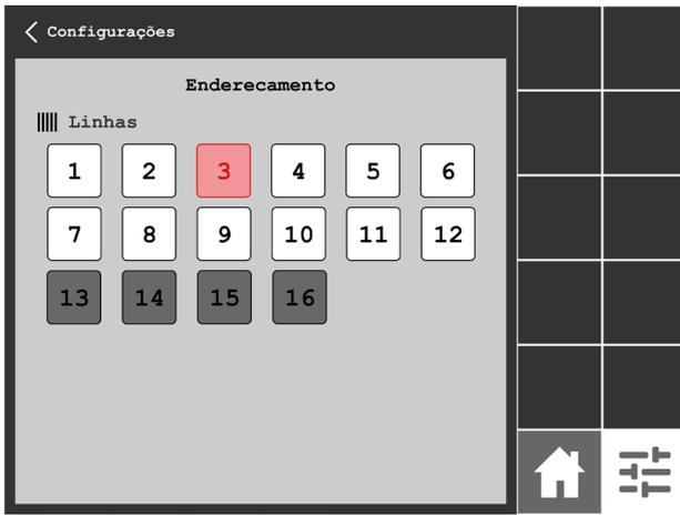
Pantalla de direccionamiento: listado con las líneas para configurar los direccionamientos.
