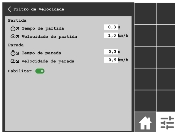
Tela de ajustes de filtro de velocidade.
