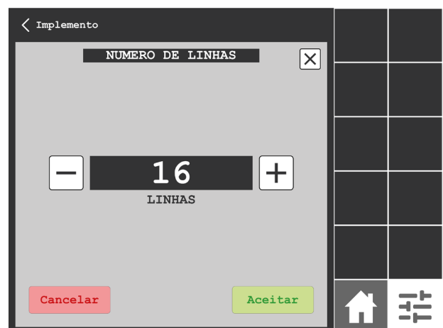
Telas de ajustes: toque no botão + ou - para aumentar e diminuir o valor desejado.
