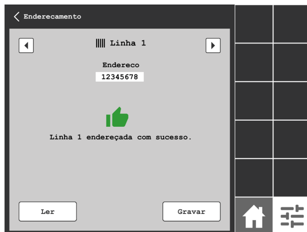
Tela endereçamento: linha endereçada com sucesso.
