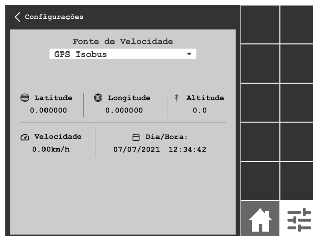
Tela Fonte de velocidade GPS Isobus.
