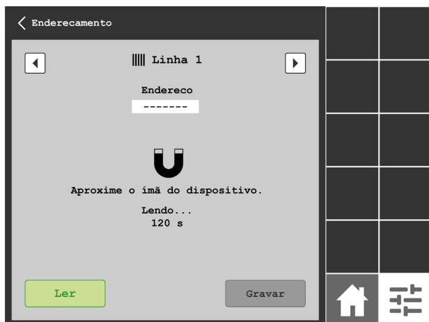
Tela endereçamento: aguardando aproximação do ímã.
