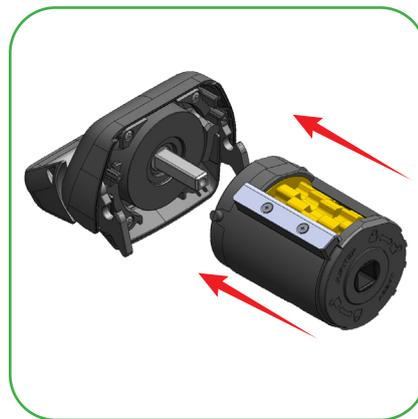
**02** Coloque a calha na tampa.
